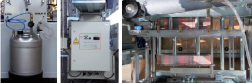
● La A 400 tiene una versatilidad operativa de 700 botes por minuto, disponiendo de un variador de frecuencia de velocidad que regula la etiquetadora en el proceso de etiquetado del bote, en más o menos cantidad a etiquetar, según necesidad del cliente.
