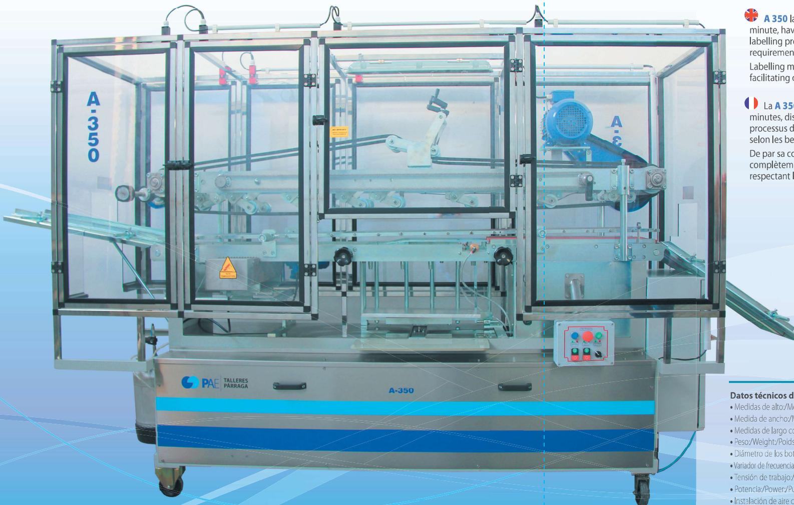
La **A 350** tiene una productividad operativa de 200 botes por minuto, disponiendo de un variador de frecuencia de velocidad que regula la etiquetadora en el proceso de etiquetado del bote, en más o menos cantidad a etiquetar, según las necesidades de producción.
